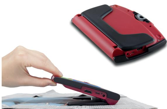
RUBY® 7 HD – это портативный ручной видеоувеличитель высокой чёткости. Данный увеличитель имеет большой 7-ми дюймовый экран, поворотную камеру, HDMI порт для подключения к ТВ, обеспечивает более продолжительное время автономной работы и многое другое.
