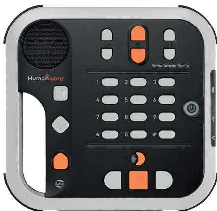
Стационарный мультимедиа плеер с беспроводной связью предназначен для воспроизведения цифровых «говорящих» книг различных форматов.
