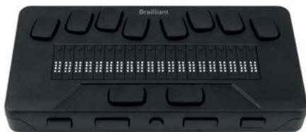
Brailliant BI 20X — это портативный обновляемый дисплей Брайля с 20 ячейками, который можно подключать к другим устройствам или использовать с автономными приложениями.
