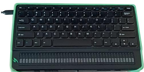
Портативный тактильный дисплей Брайля с беспроводной технологией Bluetooth® Mantis Q40 – это тифлотехническое устройство для лиц с нарушениями зрения, представляющее собой устройство, обеспечивающее тактильный доступ незрячих и слабовидящих пользователей к работе на любом персональном компьютере, ноутбуке, читающей машине, совместно с программным обеспечением экранного доступа.
